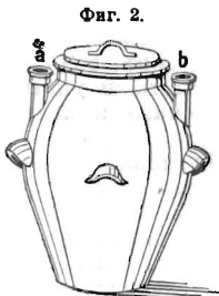
Двугорлыя газоотдѣлительныя стеклянки.
